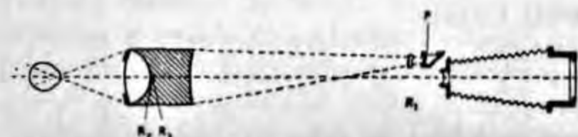
Fig. 3.—Esquema de la modificación de Hartinger al objetivo de la cámara de Nordenson
