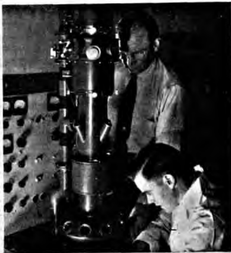
Fig. 2.—Microscopio electrónico de la RCA, con el que pueden observarse las bacterias, virus y otras pequeñas sustancias con aumento hasta de 100 000 diámetros.
