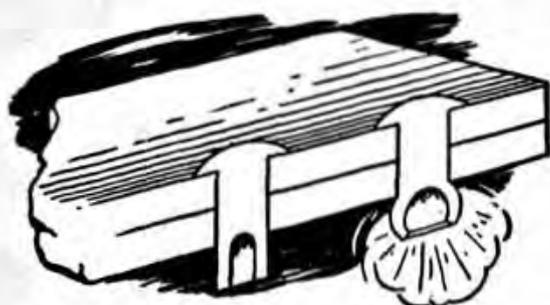
**¡"Detonando" Remaches!** Remaches con cargas explosivas en sus extremidades ahora son detonados por medio de la energía radioeléctrica. Este nuevo método de la RCA puede simplificar y acelerar grandemente las construcciones industriales.
