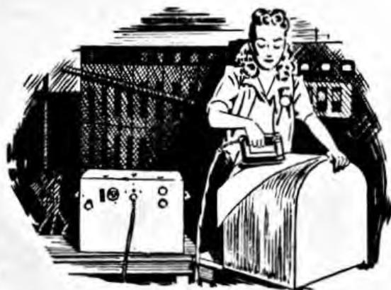
**¿Un planchador electrónico? ¡No—Un encolador electrónico!** El nuevo aparato para encolar, el RCA Spot Gluer, proyecta la fuerza electrónica a través del enchapado para calentar la cola y unir las capas de madera. Acelera la producción de aviones de madera y además ofrece grandes posibilidades en la ebanistería y otras industrias análogas.
