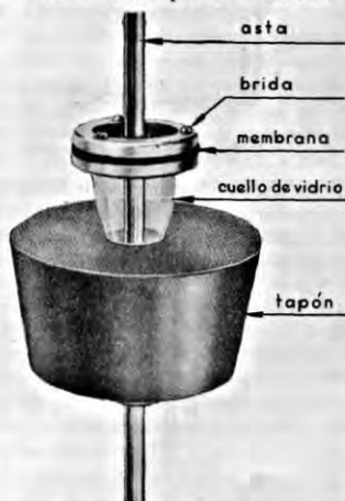
Fig. 1.—"Vibro-mezclador" de la D. G. f. Chemi-Apparatebau, de Zürich.
