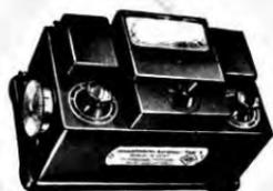
De dos celdas fotoeléctricas. Para mediciones por deflexión de aguja, por compensación al punto cero y por sustitución. Accesorios para espectrofotometría, fluoroscopia, mediciones con luz ultravioleta y reflectometría. Tubos y cubetas de 0,2 hasta 100 cm<sup>3</sup>.
