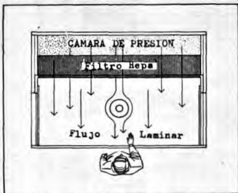
Fig. 1.—Vista desde arriba de una campana de flujo laminar mostrando carácter aerodinámico de flujo laminar.
